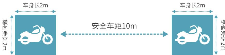
$$\text{人均动态道路时空资源消耗} = \frac{\text{出行距离} \times \text{横向净空} \times (\text{车身长} + \text{安全车距})}{\text{速度} \times \text{平均载客数}} \quad (\text{式 2-1})$$
